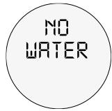
Dies signalisiert, dass nicht mehr genug Wasser im Tank ist. Bitte füllen Sie neues Wasser ein.
