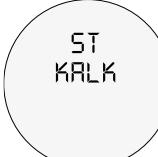
Dit is het ontkalkingsprogramma voor de stoomkringloop.
