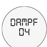
Mostra l'impostazione del vapore. È possibile scegliere se il vapore deve essere umido o secco. È possibile scegliere tra 7 livelli.
