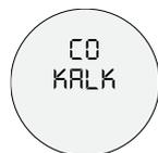
Dit is het ontkalkingsprogramma voor de zetkringloop.
