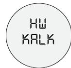
Dies ist das Entkalkungsprogramm für den Heißwasserkreislauf.
