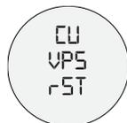
Réinitialise les réglages de profils de pression de l'utilisateur sélectionné pour les touches & aux valeurs d'usine.
