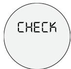
Dies bedeutet, dass der Drehregler für Dampf oder Heißwasser nicht richtig geschlossen ist.
