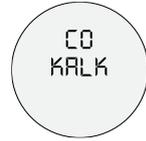
Dies ist das Entkalkungsprogramm für den Brühkreislauf.
