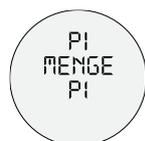
Durante la pre-infusione, il caffè in polvere nel portafiltro viene inumidito prima dell'estrazione vera e propria. È possibile impostare la durata della pre-infusione su 5 livelli. Utilizzare il livello P 0 per disattivare la pre-infusione.
