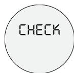
Dit betekent, dat de draairegelaar voor stoom of heetwater niet goed is gesloten.
