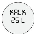
Tutaj można ustawić natężenie przepływu do następnego odkamieniania. Do wyboru są pojemności 12 litrów, 25 litrów i 50 litrów.
