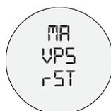
Setzt die Druckprofileinstellung für den gewählten Benutzer der manuelle Zubereitung über den Handhebel wieder auf Werkseinstellung zurück.
