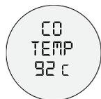
Dies zeigt die aktuelle Einstellung der Brühtemperatur. Sie haben die Möglichkeit die Brühtemperatur in +/- 1° C Schritten zwischen 86° C und 98° C zu ändern.
