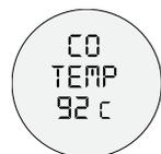
Mostra l'impostazione attuale della temperatura di erogazione. È possibile modificare la temperatura di erogazione tra 86° C e 98° C con incrementi di +/- 1° C.
