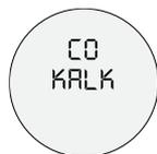
Dies ist das Entkalkungsprogramm für den Brühkreislauf.
