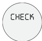
Oznacza to, że regulator obrotowy pary lub gorącej wody nie są prawidłowo zamknięte.
