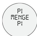
Durante la pre-infusione, il caffè in polvere nel portafiltro viene inumidito prima dell'estrazione vera e propria. È possibile impostare la durata della pre-infusione su 5 livelli. Utilizzare il livello P 0 per disattivare la pre-infusione.
