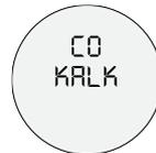
Dit is het ontkalkingsprogramma voor de zetkringloop.
