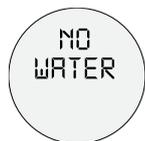
Dies signalisiert, dass nicht mehr genug Wasser im Tank ist. Bitte füllen Sie neues Wasser ein.
