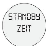
Die Zeit bis zur automatischen Abschaltung kann eingestellt werden. Einstellbar ist von OFF = AUS, 5 - 60 Min. in 5 Minuten Intervallschritten. Standardeinstellung ist 30 Minuten. Text wird durchlaufend angezeigt.
