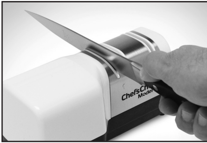
Figuur 1. Het lemmet plaatsen in de linkersleuf van fase 1. Trek het mes afwisselend in de linker- en rechtersleuf naar u toe.
