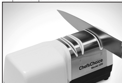
Figura 4. Cuchillo en la etapa 2. Realice pasadas de afilado hacia adelante y hacia atrás y ejerza una presión leve hacia abajo.
