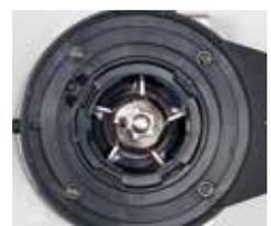
Antistatik-Einsatz und fünfteiliges Aluminium-Schaukelrad
