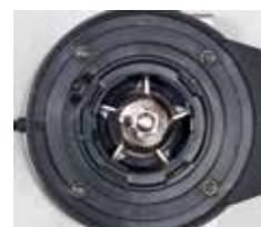
Antistatik-Einsatz und fünfteiliges Aluminium-Schaukelrad
