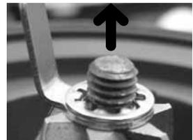
Setzen Sie **eine** Unterlegscheibe ein, um den Mahlgrad zu verfeinern oder entnehmen Sie **eine** Unterlegscheibe um eine gröbere Einstellung beim Mahlen zu erreichen.
