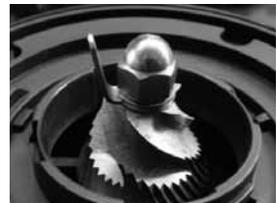
Entfernen Sie die Klemmscheibe und entfernen Sie das untere Mahlwerk.
